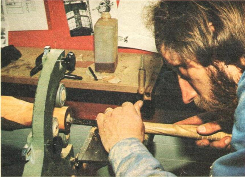
Beim Stimmen der Flöte werden die Grifflöcher durch Schaben und Bohren vergrößert oder mit Kittmasse verkleinert
